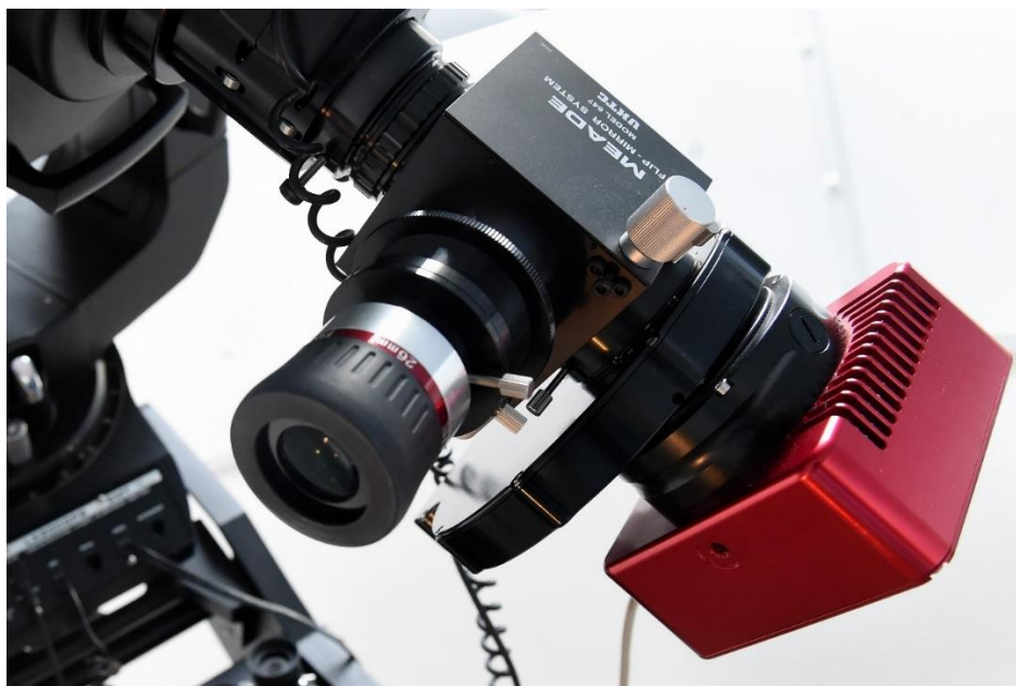
Citlivá detekční CCD kamera pomáhá s vědeckými pozorováními na observatoři WHOO!. Zdroj: Fyzikální ústav v Opavě.
